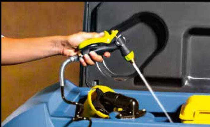
La pistola spray ha una duplice funzione. Nella fase di manutenzione della macchina agevola il risciacquo dei serbatoi al termine del turno, mentre, durante l'intervento, può essere utilizzata per inumidire macchie di sporco aderente e facilitarne la rimozione.
