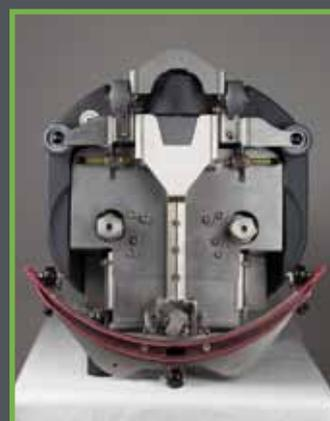
Telaio tutto in acciaio INOX AISI 304
