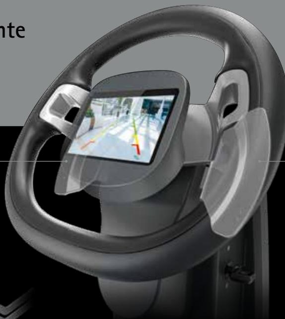
I comandi ai lati del volante aiutano l'operatore a mantenere la concentrazione sull'area di lavoro, senza pericolo di distrazioni.
