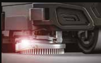
Spazzola laterale lavante (disponibile per le versioni a disco)
